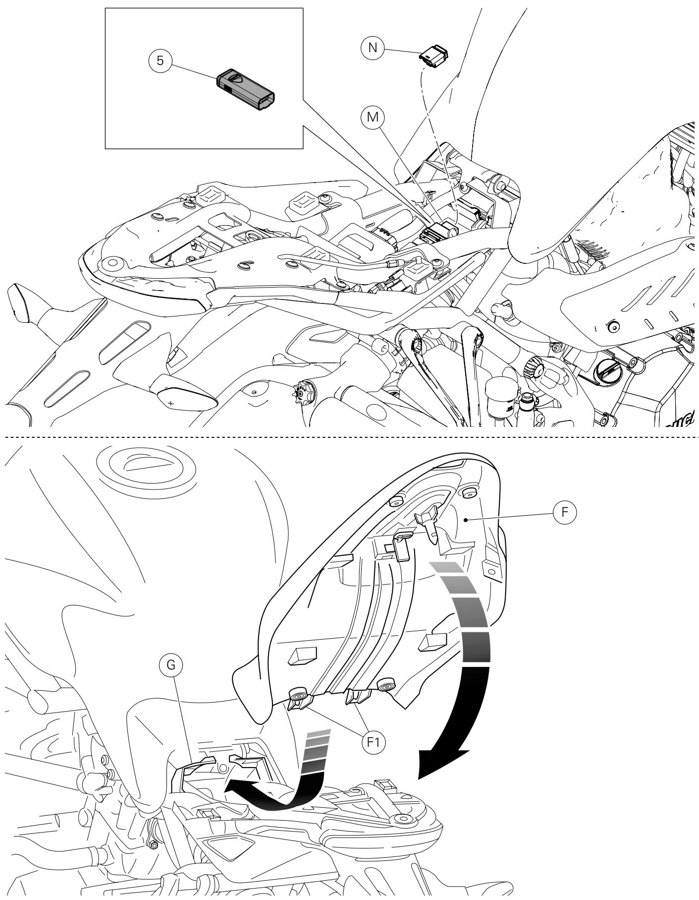
Desconectar la tapa conector (N) de la clavija (M).
