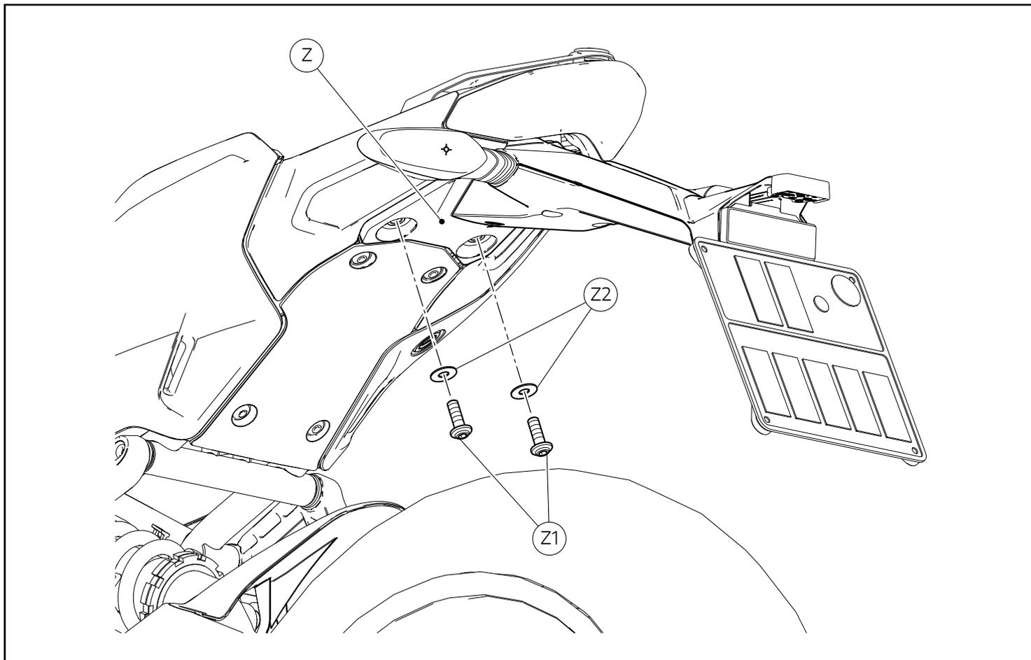
Desatarraxe os 2 parafusos (Z1) com as 2 arruelas (Z2) de fixação dianteira do suporte de matrícula (Z).
