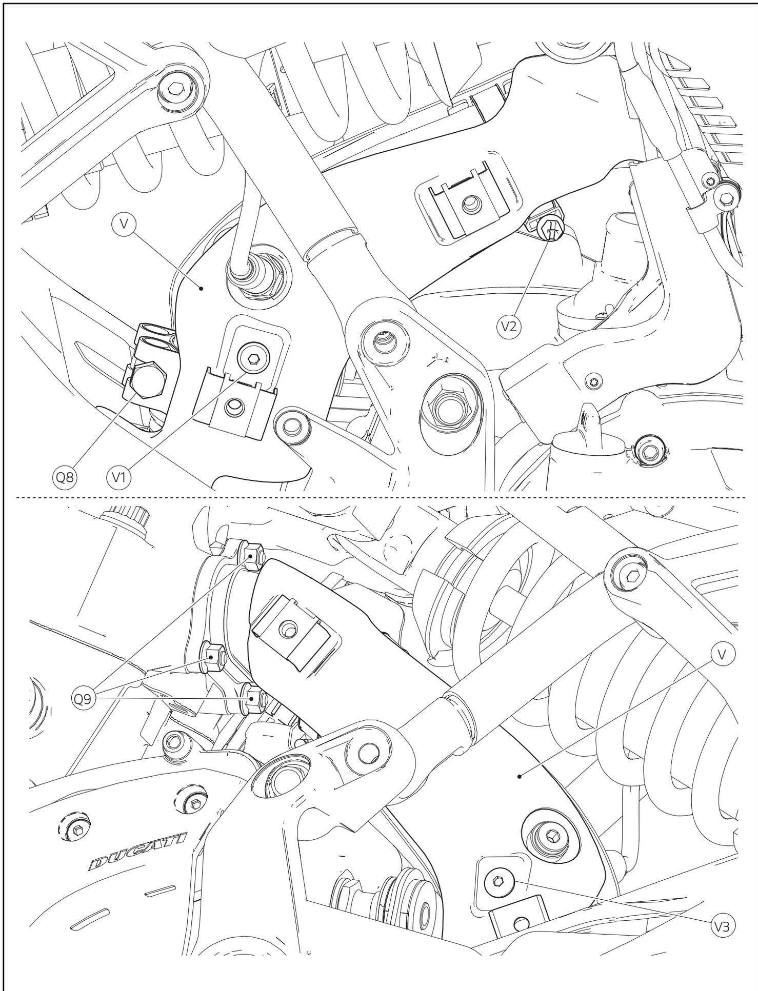
Atuando no lado direito da moto, desatarraxe o parafuso (V1) e alivie a braçadeira (V2) de fixação dianteira do protetor anticalor (V). Alivie a braçadeira de junção do coletor da cabeça vertical (Q8).
