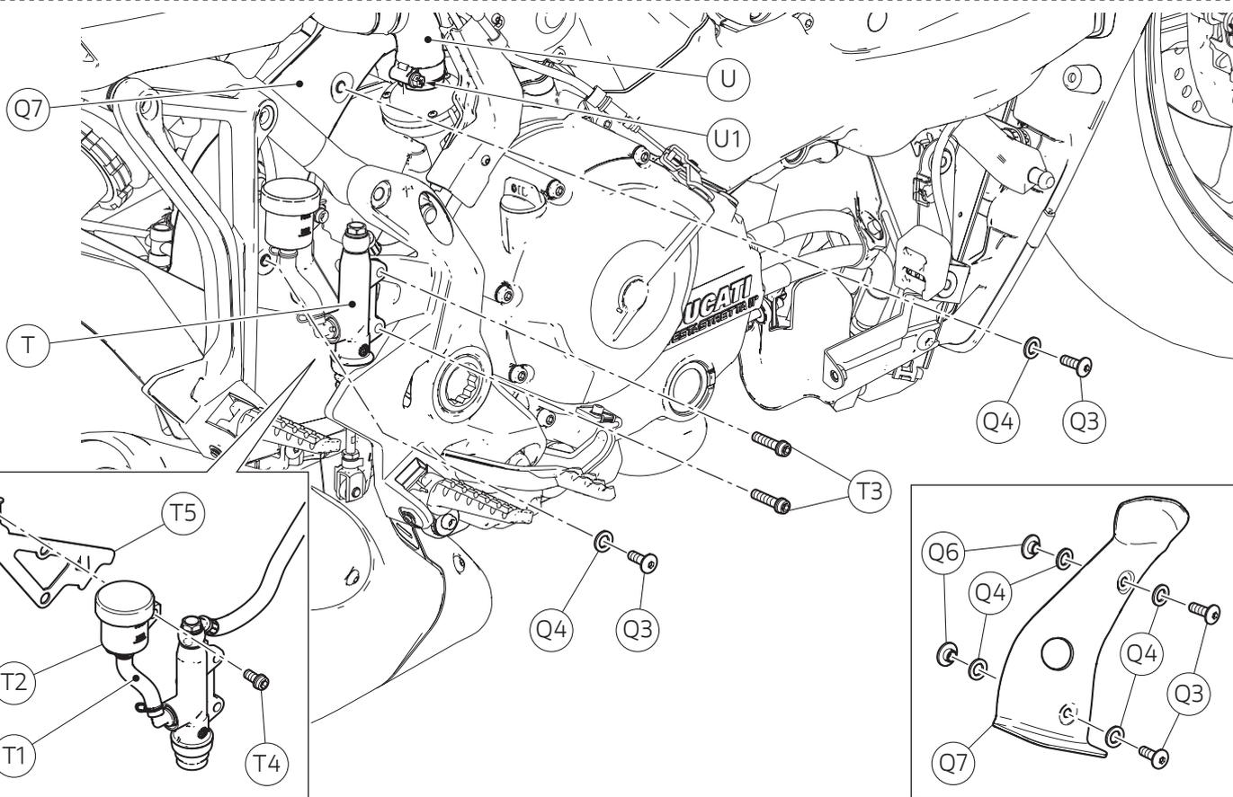
Atuando no lado esquerdo da moto, desatarraxe os 2 parafusos (Q3) com as 2 arruelas (Q4). Remova o protetor anticalor esquerdo (Q5), as 2 arruelas (Q4) e os 2 espaçadores com colar (Q6). Desatarraxe o parafuso (S1) com a arruela (S2) de fixação do suporte do silenciador (S3).
