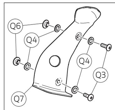
Operando en el lado izquierdo de la motocicleta, desatornillar los 2 tornillos (Q3) con 2 arandelas (Q4). Quitar el protector calor izquierdo (Q5), las 2 arandelas (Q4) y los 2 separadores con collar (Q6). Desatornillar el tornillo (S1) con arandela (S2) de fijación sostén silenciador (S3).
