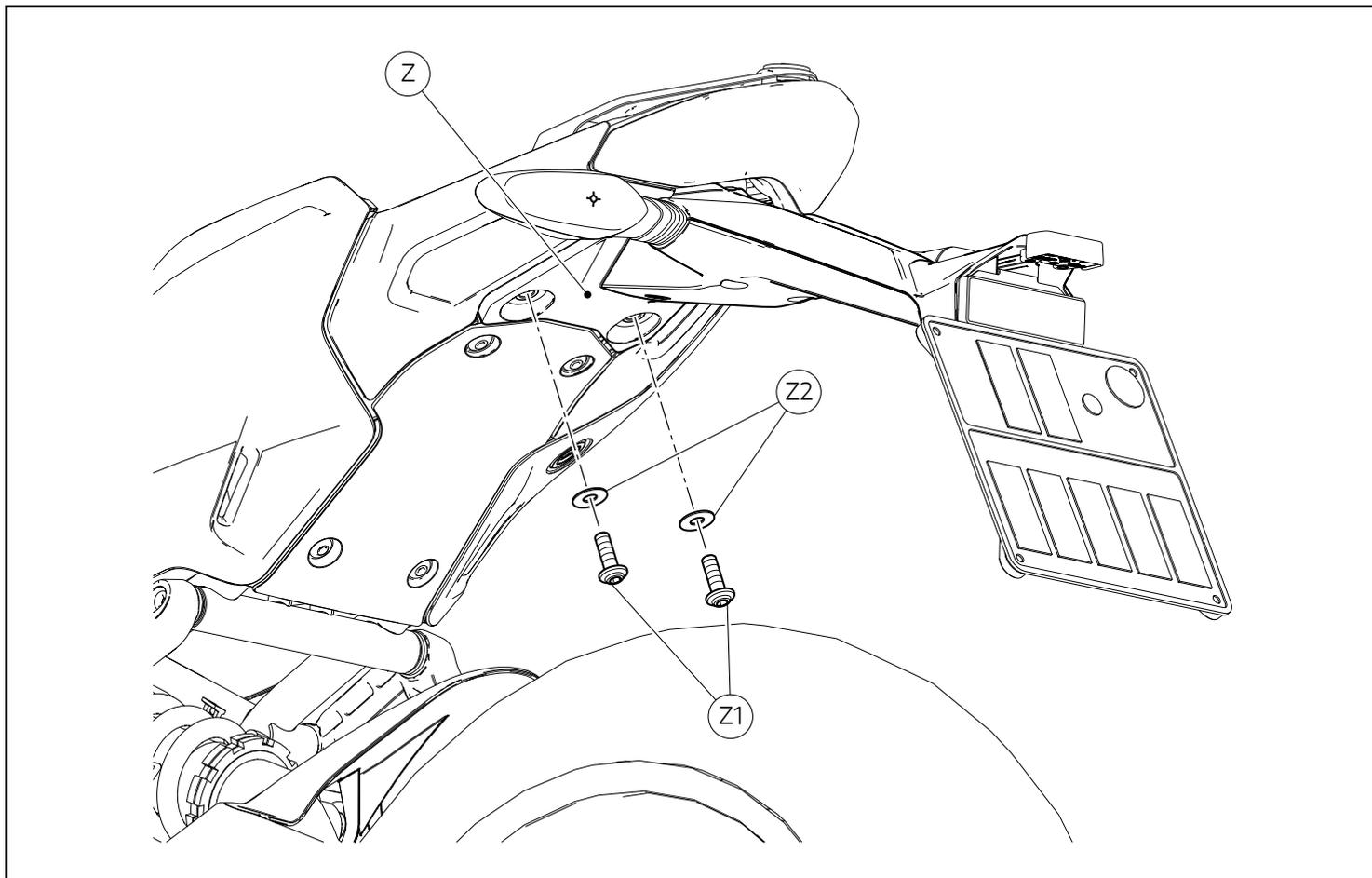
Desatornillar los 2 tornillos (Z1) con las 2 arandelas (Z2) de fijación delantera porta-matrícula (Z).
