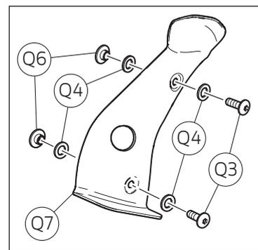
Operando sul lato sinistro del motoveicolo, svitare le n.2 viti (Q3) con n.2 rosette (Q4). Rimuovere il paracalore sinistro (Q5), le n.2 rosette (Q4) e i n.2 distanziali con collare (Q6). Svitare la vite (S1) con rosetta (S2) di fissaggio staffa silenziatore (S3).
