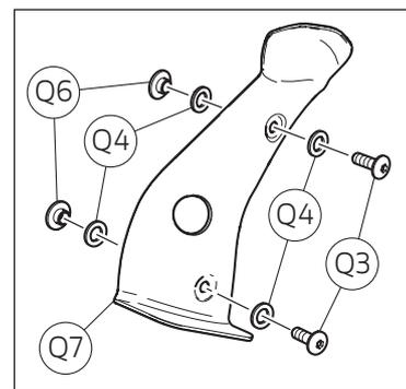
En intervenant du côté gauche du motorcycle, desserrer les 2 vis (Q3) avec les 2 rondelles (Q4). Déposer le pare-chaleur gauche (Q5), les 2 rondelles (Q4) et les 2 entretoises à collerette (Q6). Desserrer la vis (S1) avec rondelle (S2) de fixation de la bride du silencieux (S3).
