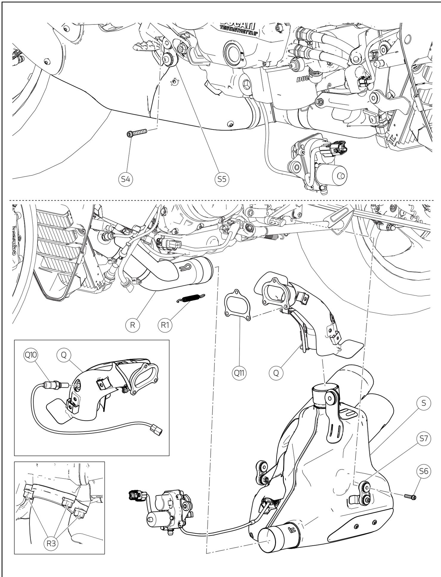
Atuando no lado direito da moto, desatarraxe o parafuso (S4) de fixação da biela lateral direita (S5).
