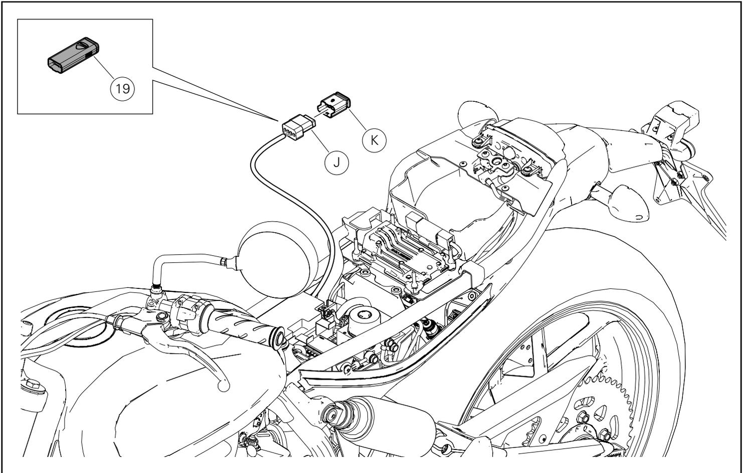
Desconectar la tapa conector (K) de la clavija (J).
