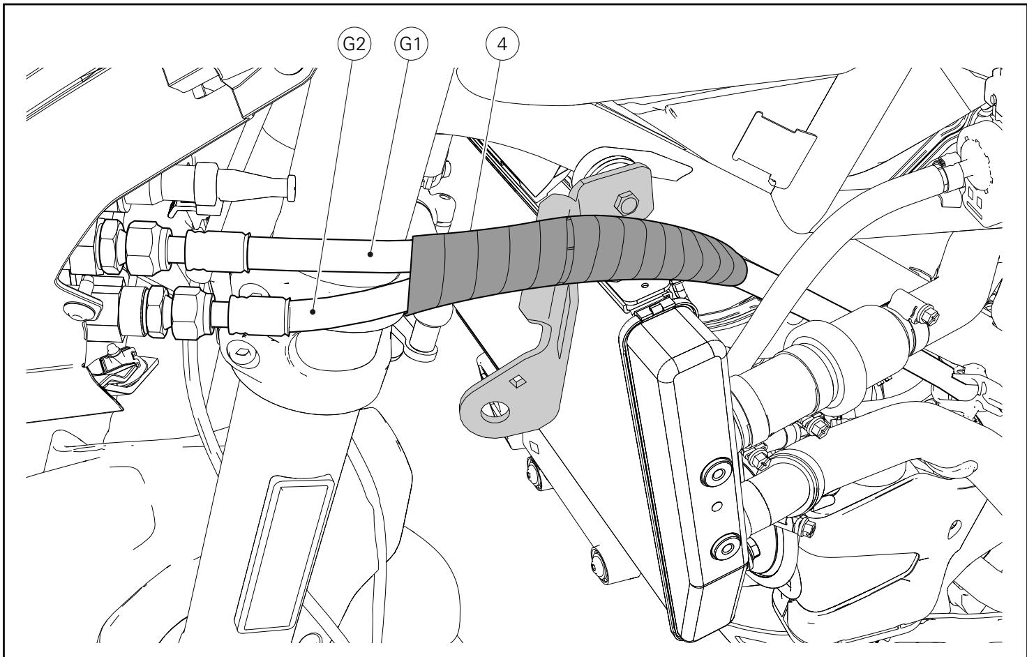
En agissant du côté gauche du motocycle, enrouler le tuyau de refoulement (G1) et le tuyau de retour (G2) du radiateur huile avec le faisceau spiralé (4), comme la figure le montre.
