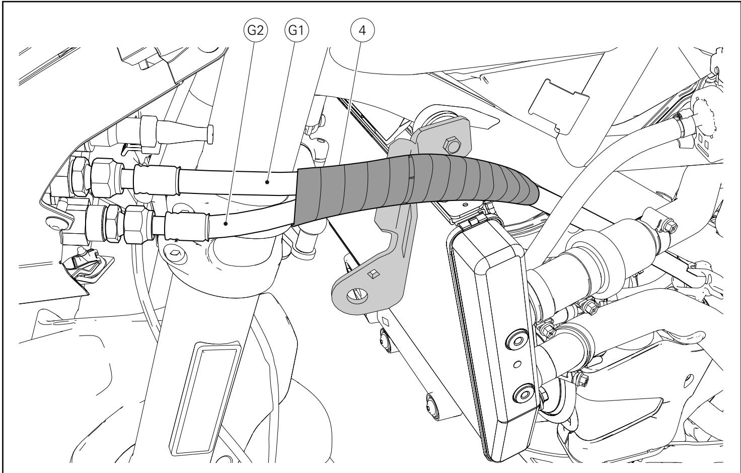
Operando del lado izquierdo de la motocicleta, envolver el tubo impulsión (G1) y el tubo retorno (G2) del radiador aceite con la espiral (4), como ilustra la figura.
