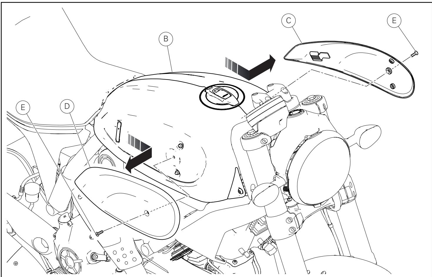
Operando da entrambi i lati del motoveicolo, svitare le n.2 viti (E) di fissaggio delle cover destra (D) e sinistra (C) al serbatoio (B).
