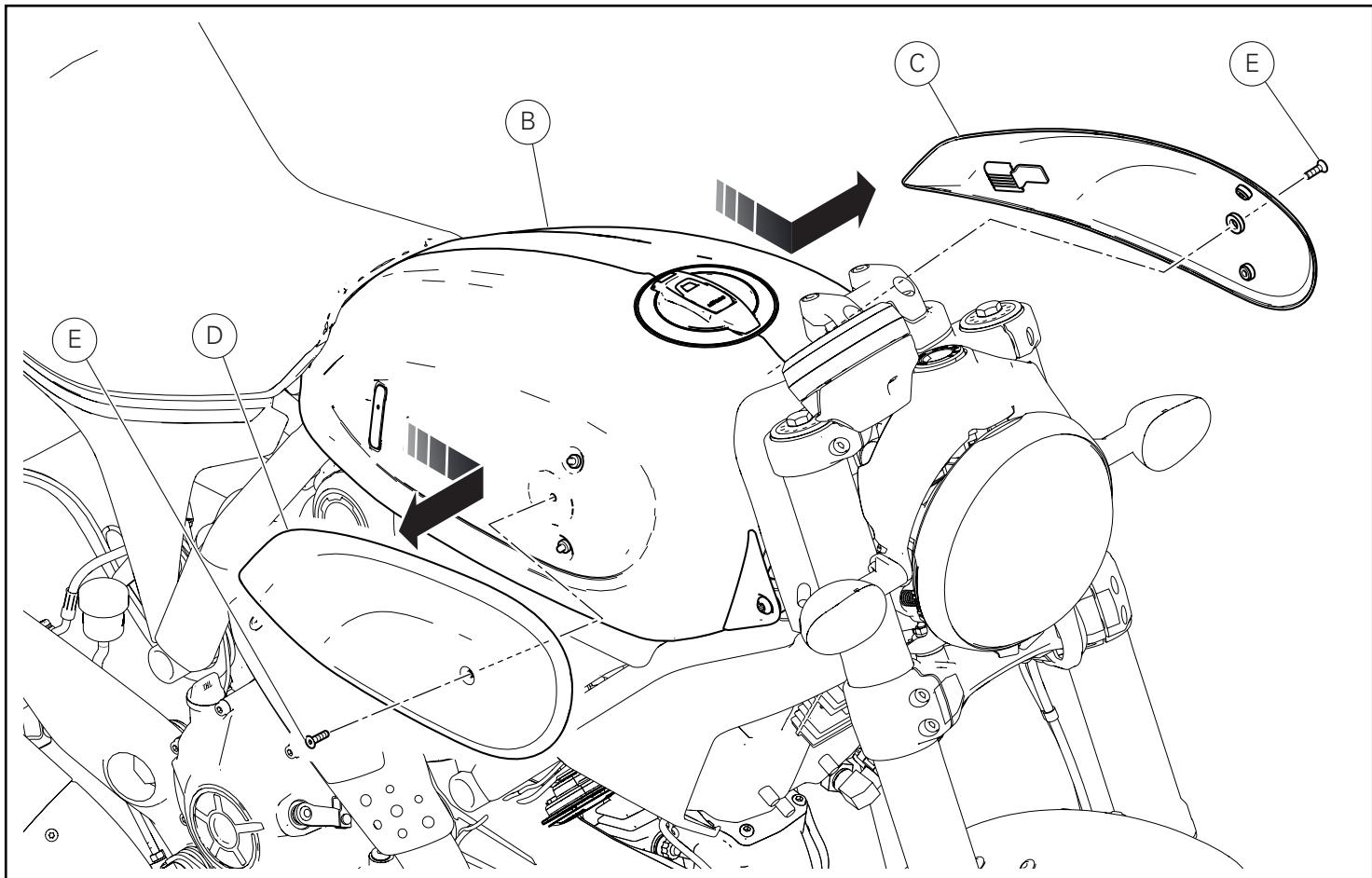
En agissant des deux côtés du motocycle, desserrer les 2 vis (E) fixant les caches droit (D) et gauche (C) au réservoir (B).
