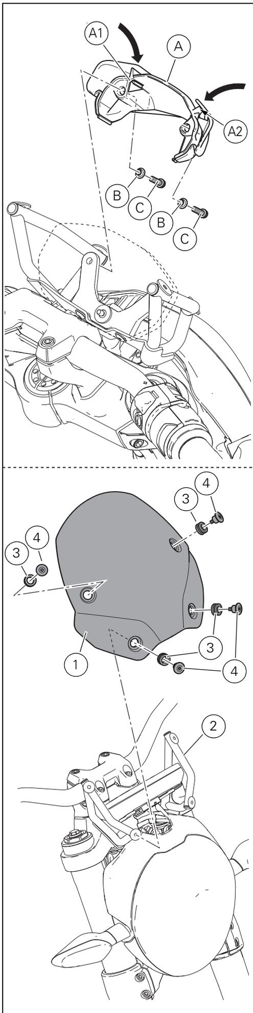
Introducir los 2 separadores originales (B) en los 2 tornillos originales (C).
