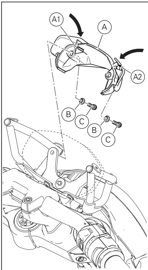
Insira os 2 espaçadores originais (B) nos 2 parafusos originais (C).
