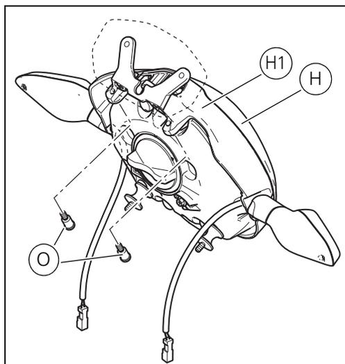
Desatornillar los 2 pernos roscados (O) del soporte faro (H1)..
