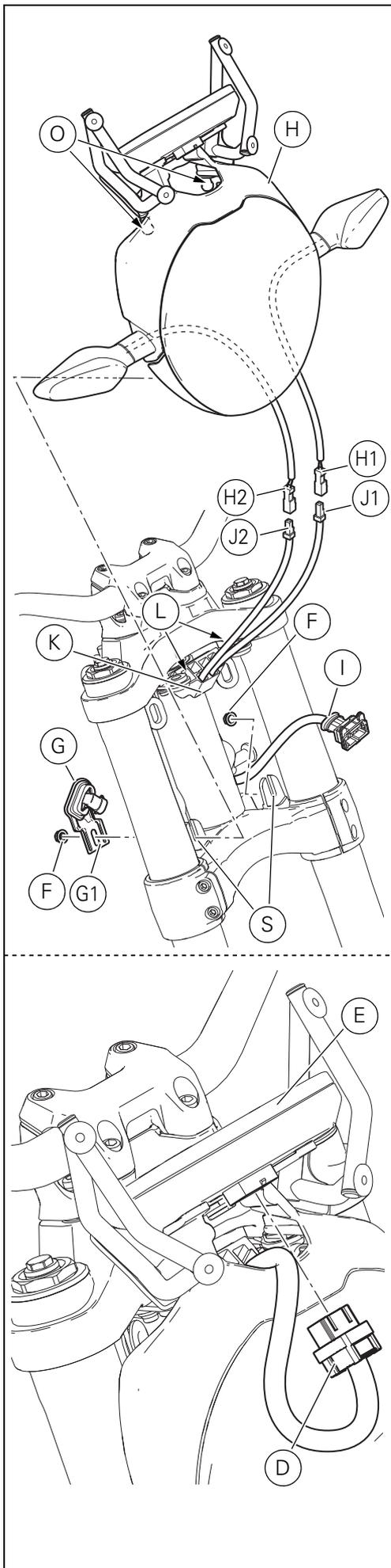
Conectar las tomas (H1) y (H2) de los indicadores de dirección a sus respectivas clavijas (J1) y (J2) del cableado principal. Introducir la conexión de los indicadores de dirección en el soporte conectores (K).
