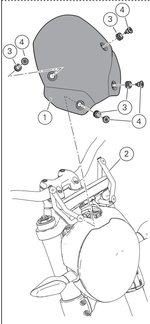
Monte os 4 anéis de borracha (3) no para-brisas (1), ajudando-se com álcool ou água com sabão.
