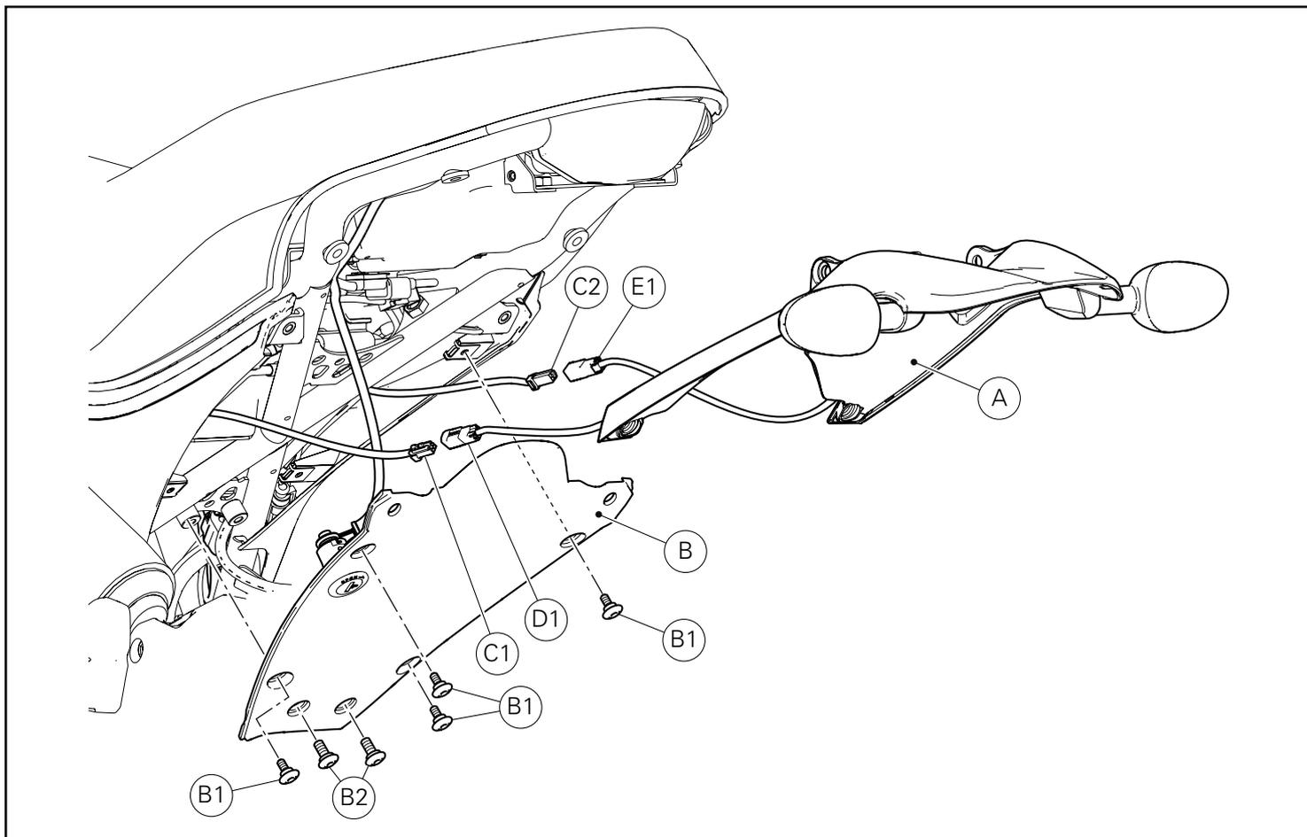
Desserrer les 4 vis (B1) et les 2 vis (B2).
