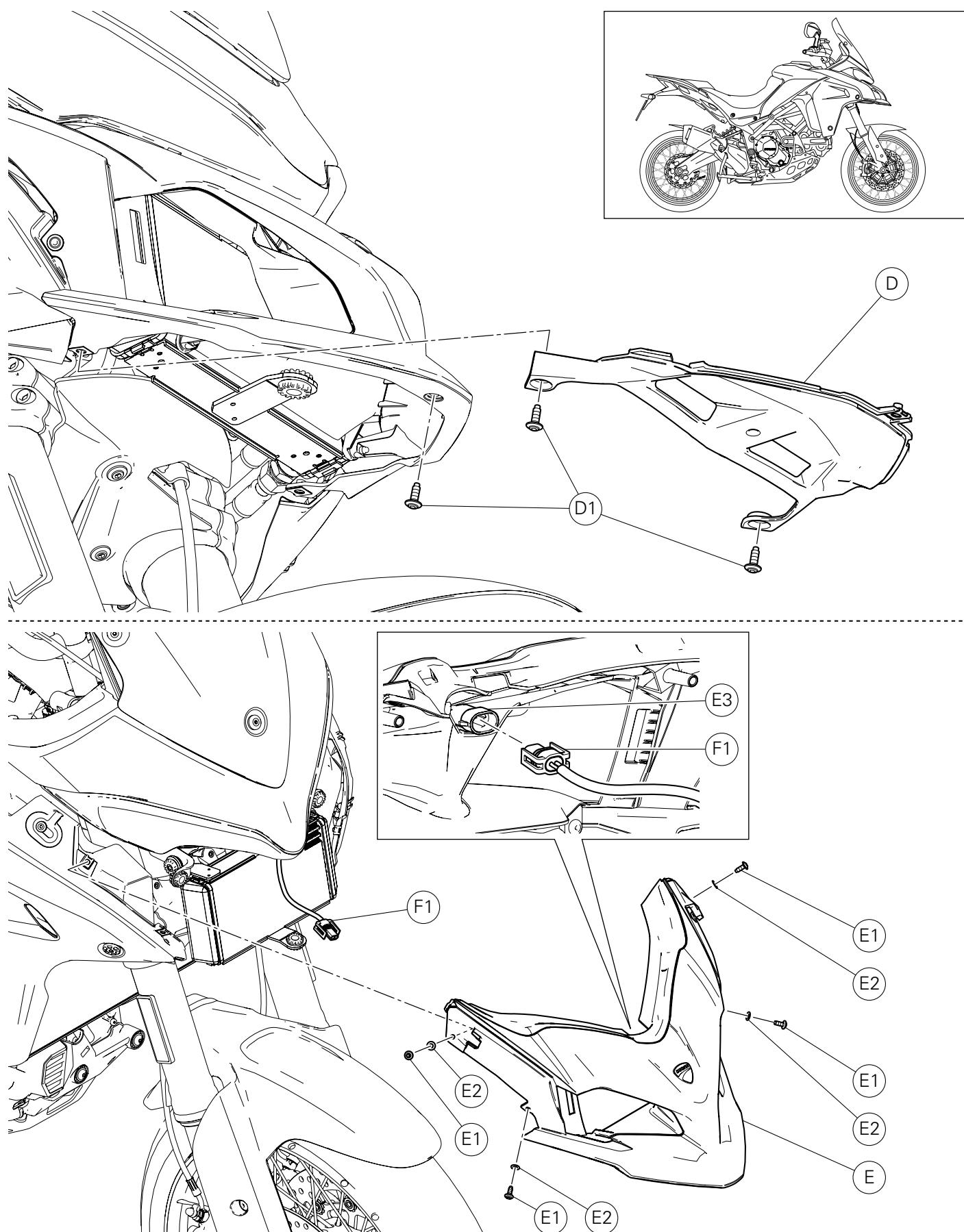
Dépose du panneau inférieur
