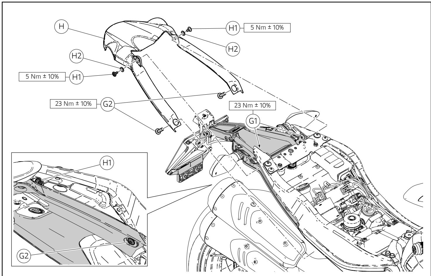
Posizionare il parafango posteriore superiore (H) ed impuntare le n. 2 viti originali (G2). Inserire le n.2 rosette originali (H2) sul filetto delle n.2 viti originali (H1). Impèuntare le n.2 viti (H1). Serrare alla coppia indicata le n.2 viti (H1), le n.2 viti (G2) e le n.2 viti (G1).
