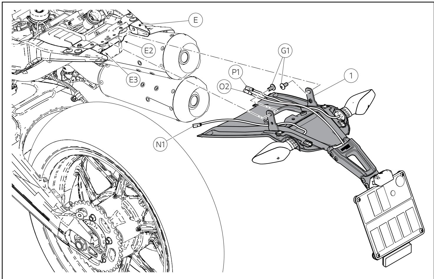
Posizionare il gruppo telaietto portatarga (1) facendo passare il cablaggio indicatore di direzione destro (P1) e il cablaggio luce targa (O2) attraverso l'apertura (E2) e, il cablaggio indicatore di direzione sinistro (N1) attraverso l'apertura (E3). Fissare il gruppo telaietto portatarga (1) al telaietto (E) del motoveicolo impuntando, senza serrare, le n.2 viti originali (G1).
