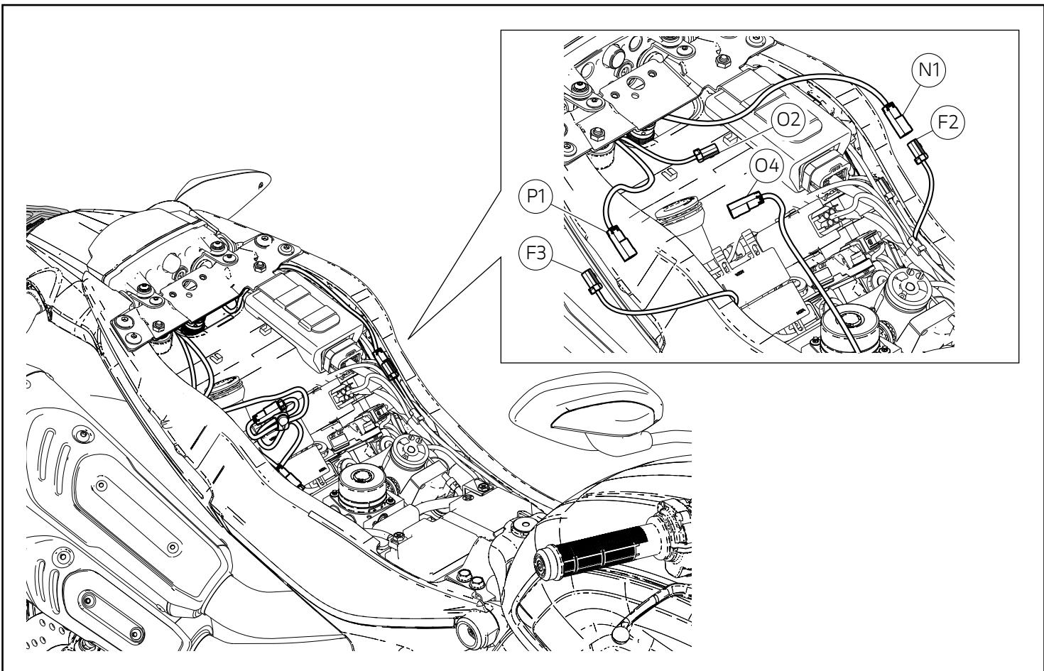
Collegare la luce targa (O2) alla prolunga luce targa (O4). Ripristinare i collegamenti dei cablaggi indicatore sinistro (N1) e destro (P1) alle spine (F2) e (F3) del cablaggio principale. Raccogliere le eccedenze del collegamento luce targa e fascettare insieme al cablaggio dell'indicatore destro, posizionando le eccedenze sul lato destro del telaietto come mostrato in figura.
