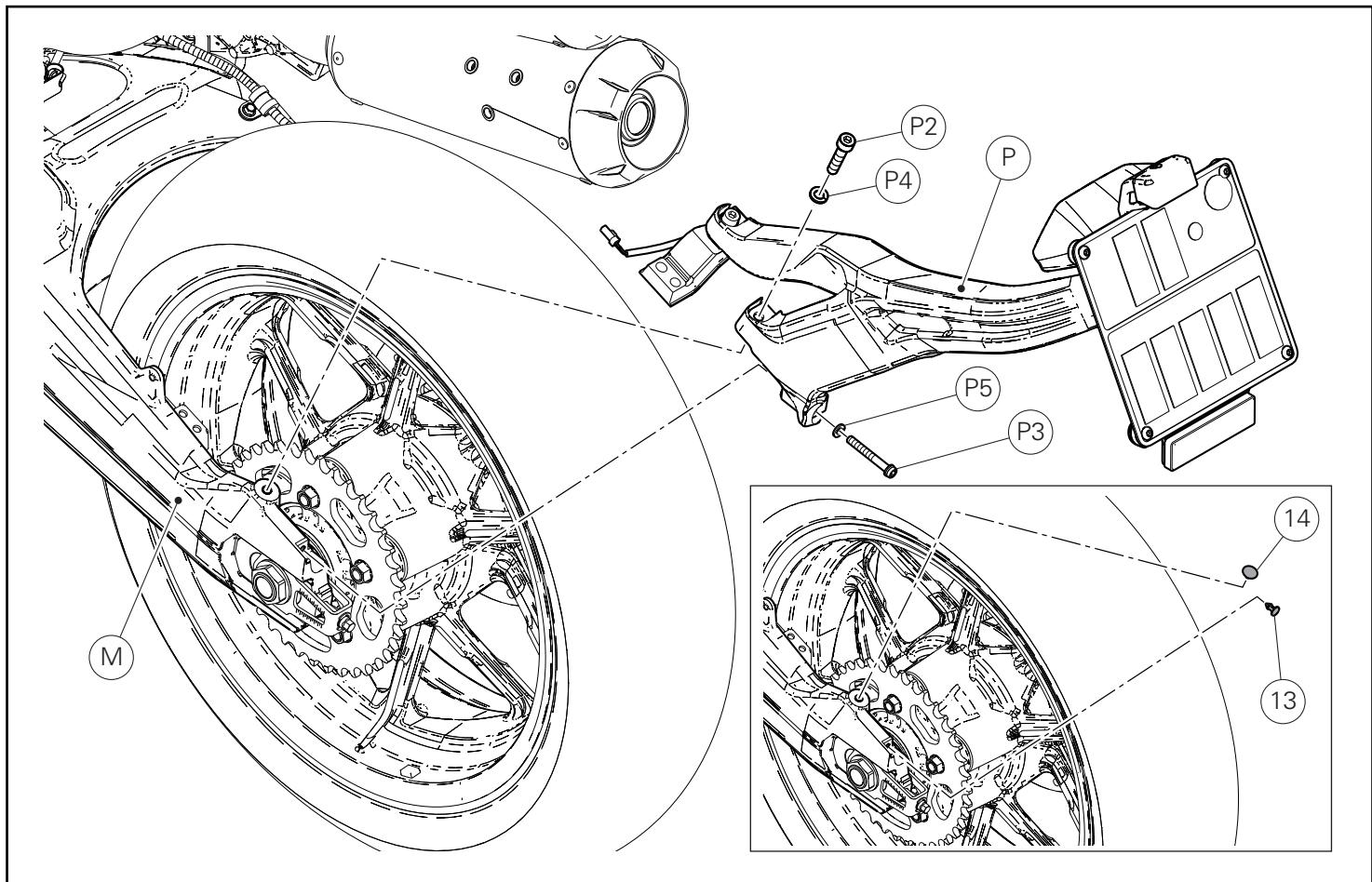
Operando sul lato sinistro del motoveicolo, svitare e rimuovere la vite (P2) completa di rondella (P4) e la vite (P3) completa di rondella (P5). Rimuovere il gruppo portatarga (P) dal forcellone (M).
