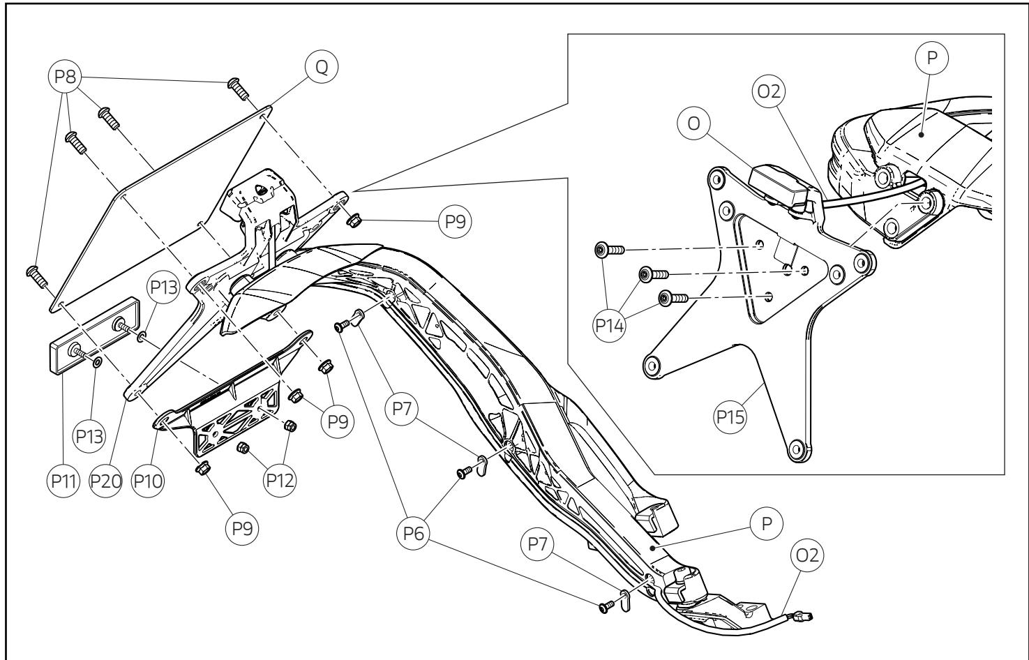
Svitare le n.3 viti (P6) e rimuovere i n.3 ferma cavo (P7) di fissaggio cablaggio luce targa (O2). Svitare le n.2 viti inferiori (P8), mantenendo dal lato opposto i corrispettivi dadi (P9) e rimuovere la piastra (P10) completa di catadiottro (P11). Svitare le rimanenti n.2 viti (P8), mantenendo dal lato opposto i n.2 dadi (P9) e smontare la targa (Q). Conservare le n.4 viti (P8) e i n.4 dadi (P9).
